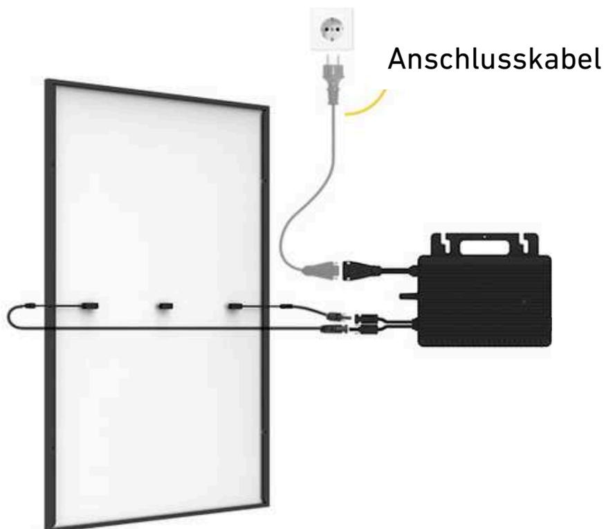
**Schritt 3.1:** Solltest du ein Balkonkraftwerk mit 2-4 Modulen montieren, schließe nach und nach die restlichen Module an den Wechselrichter an. Auf den folgenden Seiten findest du das zu deiner Anlage passende Anschlussschema.
